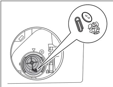
٢. ضع وعاء ماء مناسباً أسفل تجويف مضخة التصريف لتجميع المياه المتدفقة للخارج. اضغط على الذراعين واسحب قناة التصريف للسماح بتدفق المياه للخارج.
